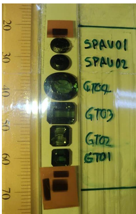
รูปที่ 1.7 แสดงขนาดลำแสงที่เหมาะสมกับตัวอย่าง และแสดงการวัดแนวลำแสงให้ตรงกับทุกชิ้นตัวอย่าง โดยใช้กระดาษ Burn paper
