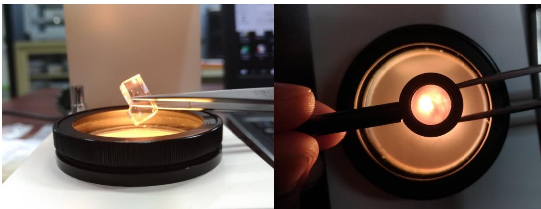
รูปที่ 1.2 ภาพการหาแกนแสงของอัญมณี โดยใช้เครื่องโพลาริสโคป (Polariscope)
